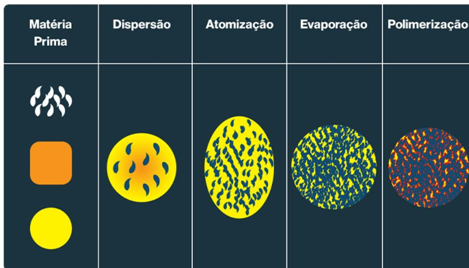
Figura 5. Etapas da síntese das partículas de resina composta pré-polimerizada SphereTEC®.
